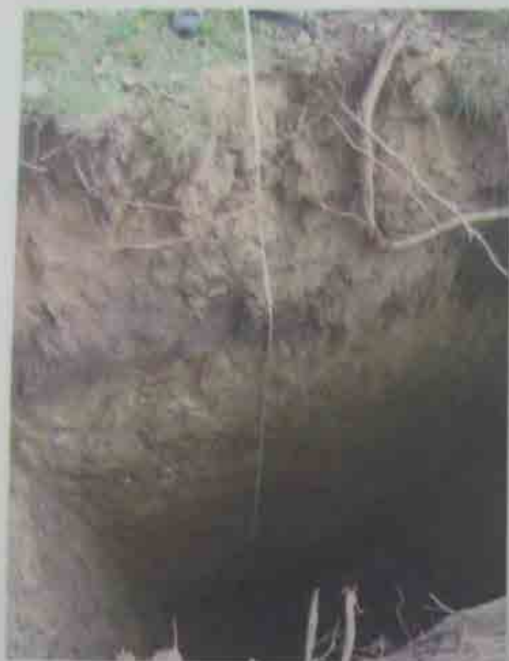
FOTO 5: Sezione esposta del pozzetto esplorativo P3.
