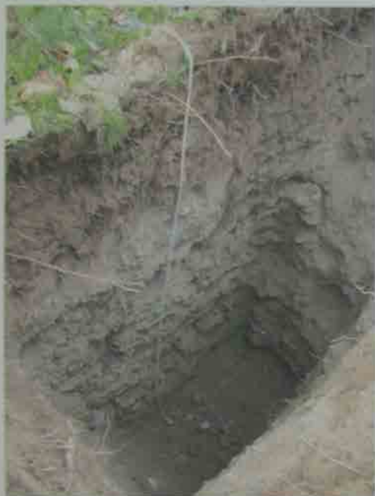
FOTO 1: Sezione esposta del pozzetto esplorativo.
