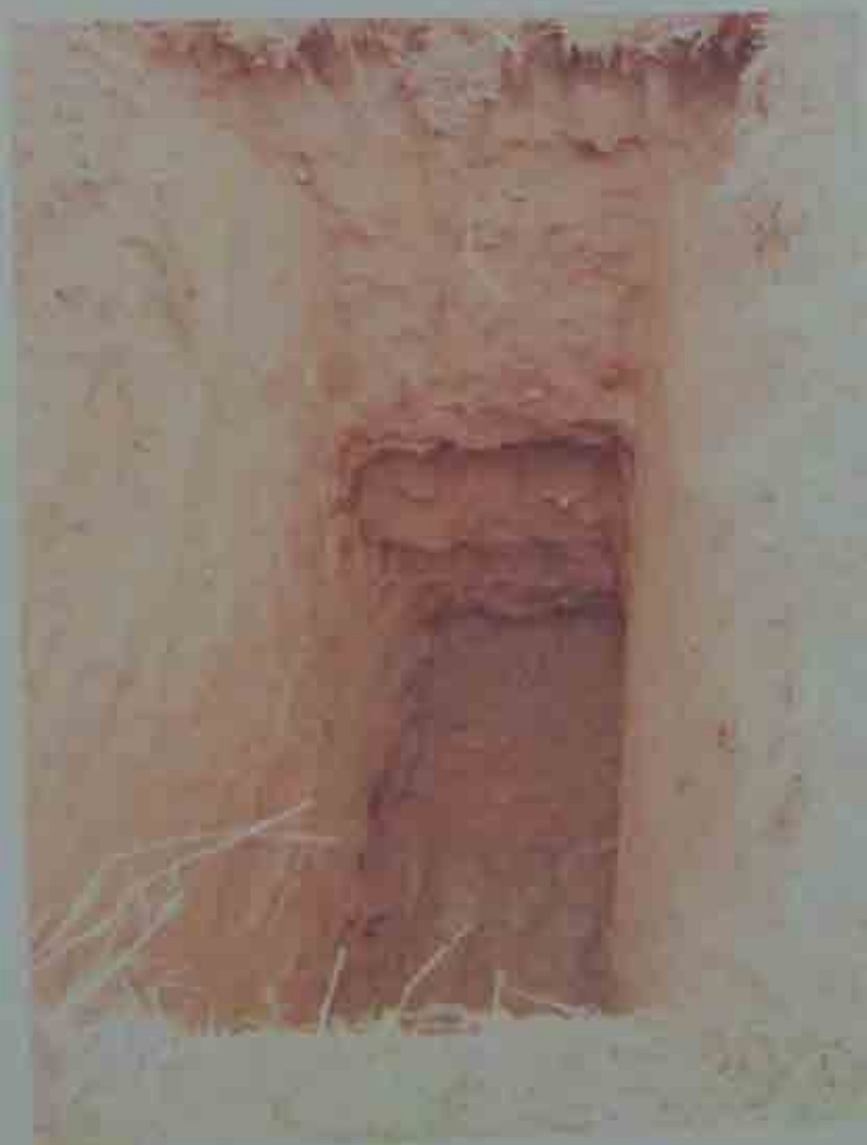
Pozzetto esplorativo eseguito
