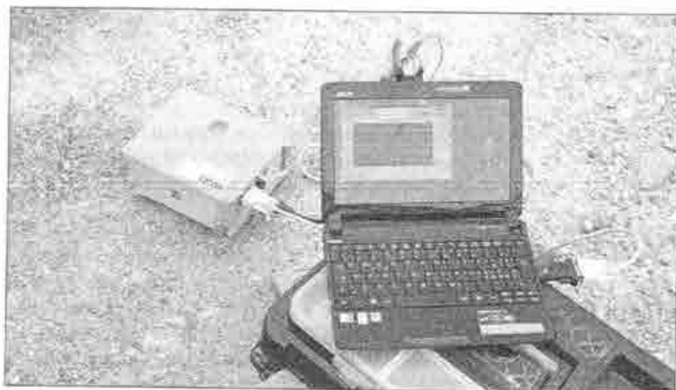
Figura 4 – Stazione sismica H.V.S.R. nel sito di progetto, dettaglio strumentazione utilizzata
